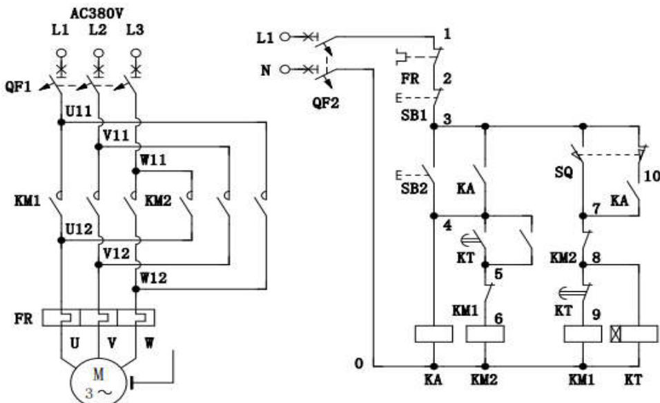
图 3 电机控制电路原理图 (举例)
